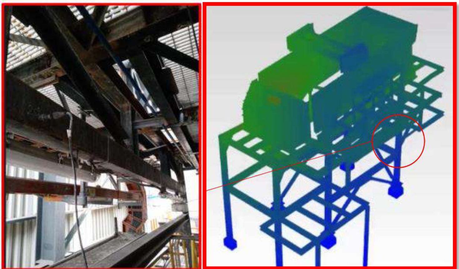
Fig. 3 – Identificación de frecuencias naturales por excitación de estructura y modelado computacional para análisis Modal
